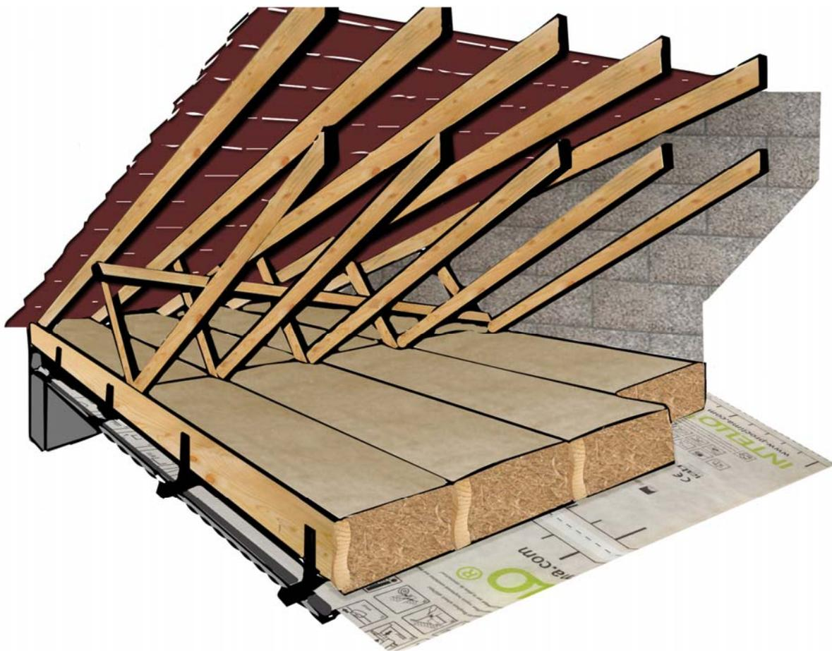
Figure 24 : Cas de combles perdus avec une charpente industrielle
